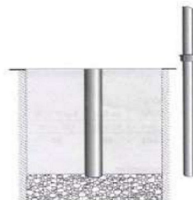
Manžeta- strediaci klín sa naráži do zemného držania. Je nutné dbať na vybranie kanálu skrutky
