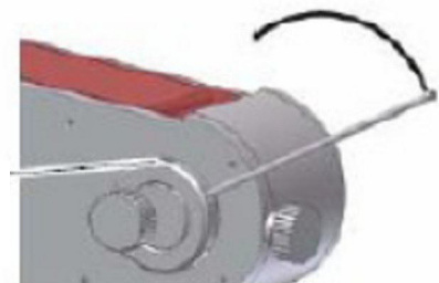
Obr. 4-9: Povoľiť hriadeľovú maticu
