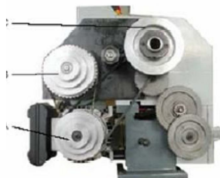
Obr. 5-18: Remenicový pohon D 280 x 700 G
